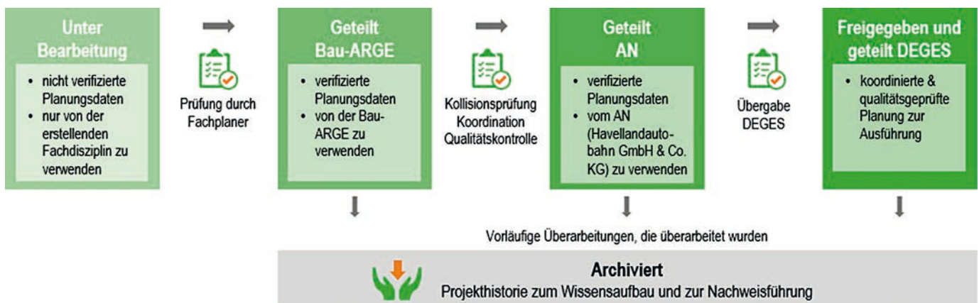
Bild 6 Container-Zustände und Status der Modelle im Verfügbarkeitsmodell A 10/A 24 [4] Container states and status of the models in the availability project A 10/A 24
